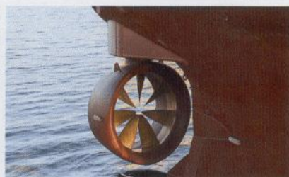
KLAR: En rimdrevet thruster er montert og skipt klar til sjøsetting.
