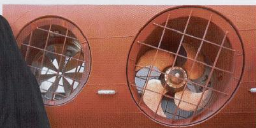
TEST: Envanlig tunnelthruster til høyre og en rimdrevet til venstre. Sistnevnte testes.
